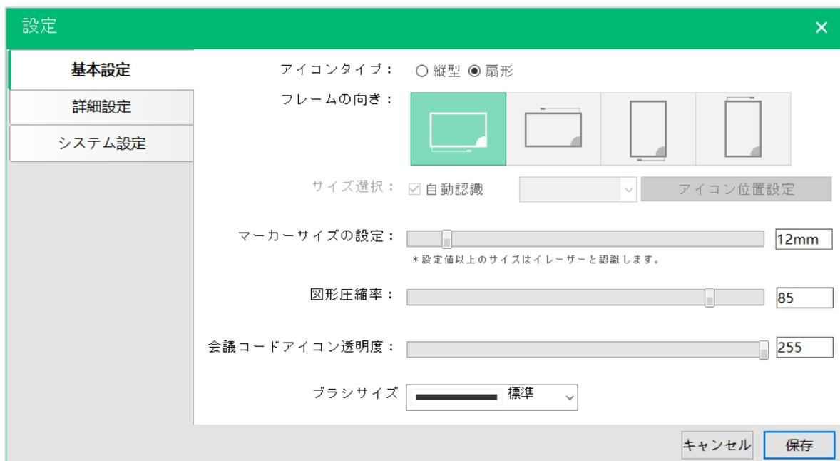
(図 8) 【基本設定】画面: タッチフレーム初回使用時にはアイコンタイプとフレームの向きを正しく設定しておく必要があります
